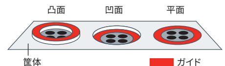
図4: 粘着材付きベントの正しい位置を確認するためにガイドを使用
