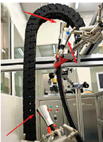
図1：ケーブルチェーンの重要エリアに設置したパーティクルカウンター
